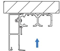
**E** Laufwagen und Stopper in das Profil einsetzen.
